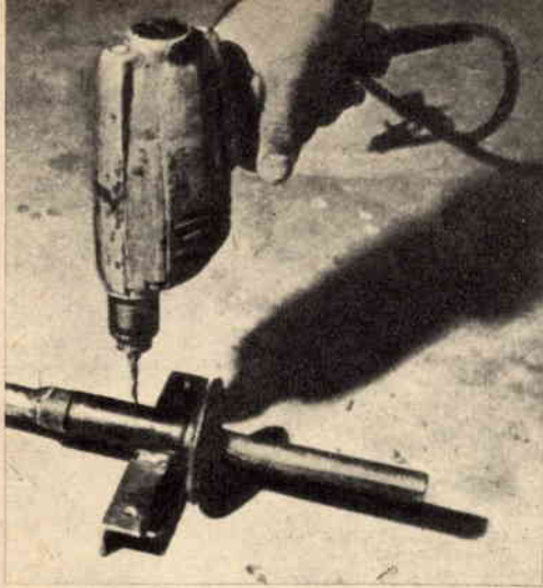
Fig. 12 - Sulle due boccole laterali e su quella centrale, eseguiremo i fori indispensabili per la lubrificazione.
